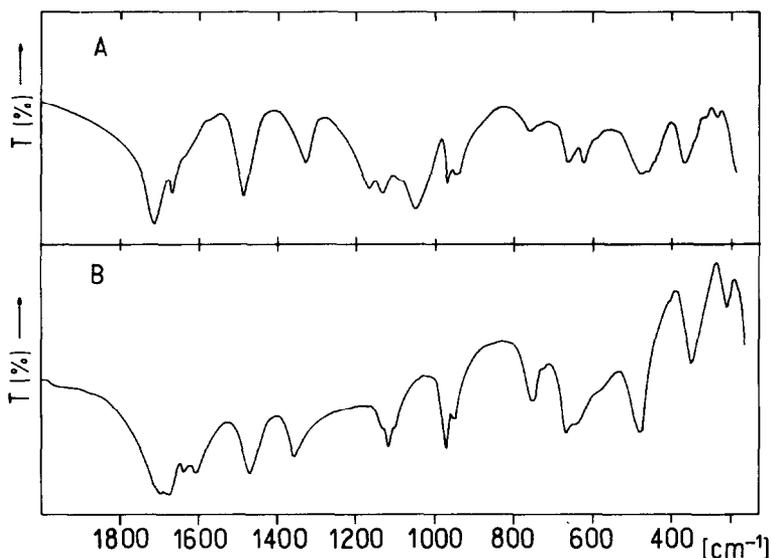
Fig. 1. IR spectra of  $\text{VO}(\text{biur})\text{SO}_4 \cdot 3\text{H}_2\text{O}$  (A) and  $\text{VO}(\text{biur})_2\text{Cl}_2 \cdot 3\text{H}_2\text{O}$  (B).
