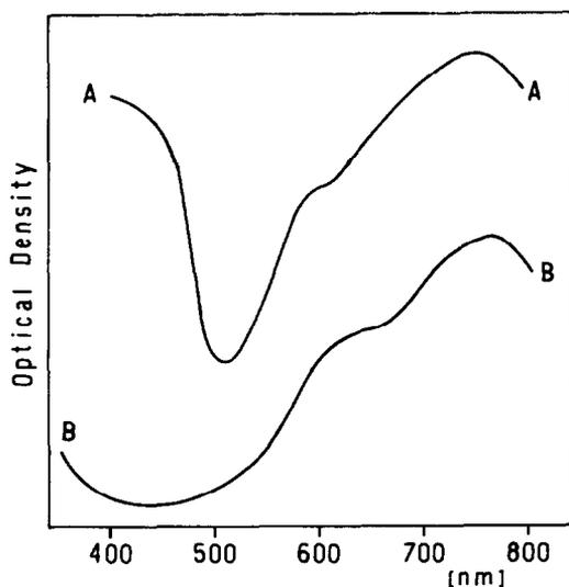
Fig. 2. Electronic reflectance spectra of  $\text{VO}(\text{biur})\text{SO}_4 \cdot 3\text{H}_2\text{O}$  (A) and  $\text{VO}(\text{biur})_2\text{Cl}_2 \cdot 3\text{H}_2\text{O}$  (B).
