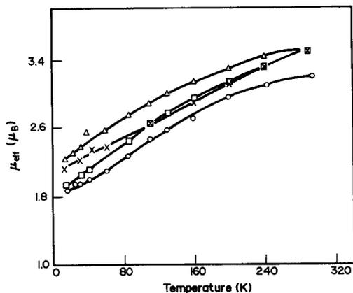
Fig. 1.  $\mu_{\text{eff}}$  vs  $T$  plots of the iron(III) amino acid complexes: (—×—)  $\text{Fe}(\text{met})(\text{OH})\text{Cl} \cdot 2\text{CH}_3\text{OH}$ , (—○—)  $\text{Fe}(\text{asn})(\text{OH})\text{Cl} \cdot 2\text{CH}_3\text{OH}$ , (—□—)  $\text{Fe}(\text{phe})(\text{OH})\text{Cl} \cdot 2\text{CH}_3\text{OH}$ , and (—△—)  $\text{Fe}(\text{his})(\text{OH})\text{Cl} \cdot 2\text{CH}_3\text{OH}$ .
