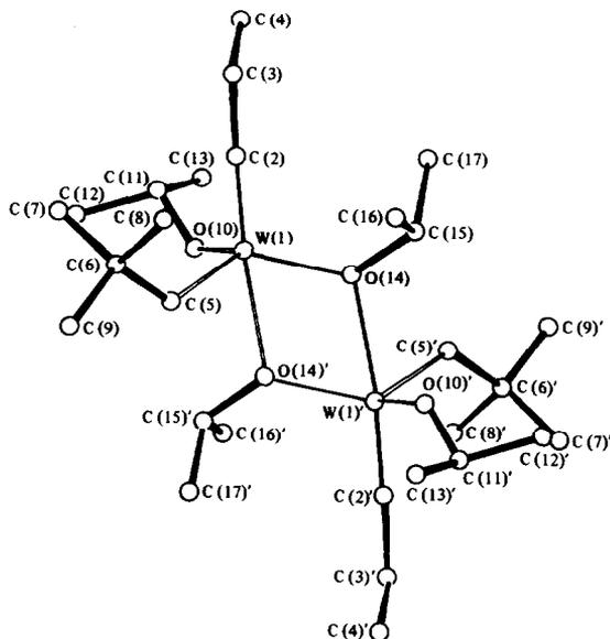
Fig. 3. A ball-and-stick drawing of the  $[\text{W}(\equiv\text{Ct})(\text{CH}_2\text{Bu}')(\text{OPr}^i)_2]_2$  molecule. Pertinent bond distances (Å) and angles (°):  $\text{W}(1)\text{-C}(2) = 1.765(7)$ ;  $\text{W}(1)\text{-C}(5) = 2.105(7)$ ;  $\text{W}(1)\text{-O}(14) = 1.961(5)$ ;  $\text{W}(1)\text{-O}(14') = 2.365(5)$ ;  $\text{W}(1)\text{-O}(10) = 1.882(5)$ ;  $\text{W}(1)\text{-W}(1') = 3.514(1)$ ;  $\text{W}(1)\text{-O}(10)\text{-C}(1) = 134.6$ .
