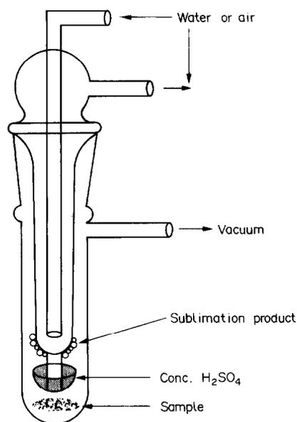
Fig. 1. Subliming apparatus.
