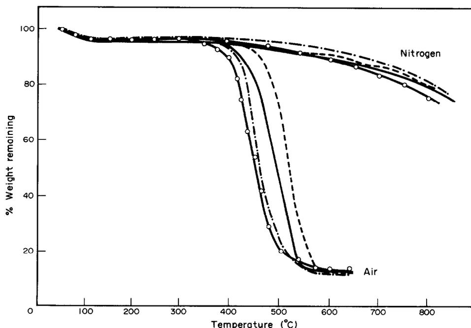
Fig. 2. Dynamic thermogravimetric analytical curves of: (1)  $\text{CuPTA} \cdot 2\text{H}_2\text{O}$  (—), (2)  $\text{CoPTA} \cdot 2\text{H}_2\text{O}$  (----), (3)  $\text{NiPTA} \cdot 2\text{H}_2\text{O}$  (- · - · -), and (4)  $\text{ZnPTA} \cdot 2\text{H}_2\text{O}$  (-○-○-○-).
